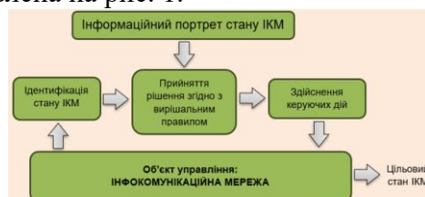
Рис.1. Інформаційна структура циклу управління захистом інформації в ІКМ.
