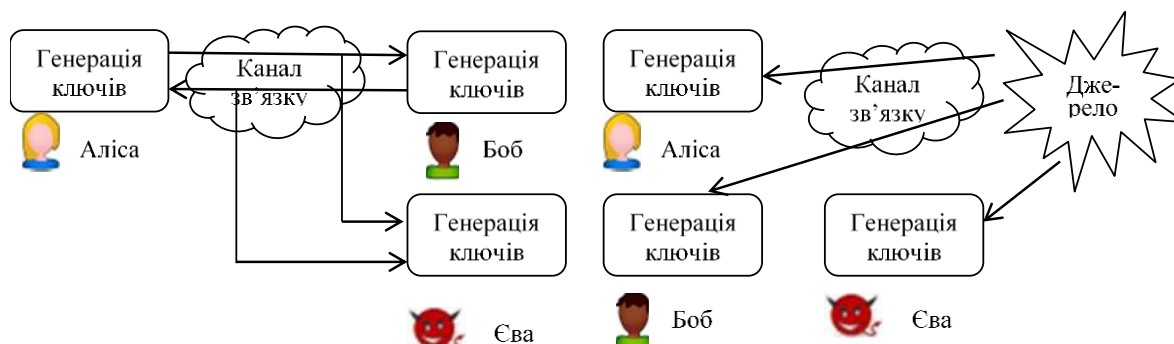
Рис. 4. Модель системи для генерації ключів на основі радіо та аудіо
